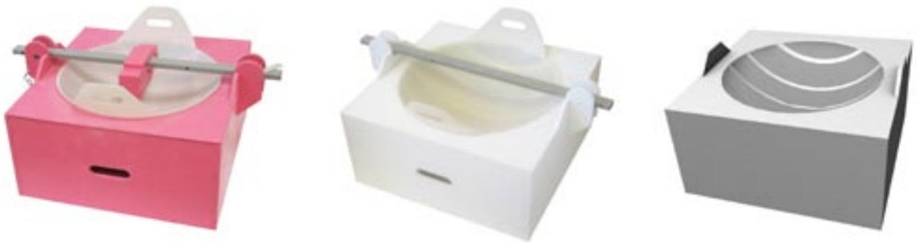
Meuble permettant le coulage et le moulage des pastilles en béton dense.
